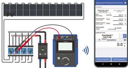
Con esta función, puede encontrar un panel solar con falla a tierra. Lo más probable es que haga esto después de encontrar una falla de aislamiento en su cadena solar. Al medir el voltaje en el interruptor de desconexión y enviarlo a GENNECT Cross, el software localizará el panel con la falla a tierra. El IR5051 utilizado para esto puede medir voltajes de hasta 2000 V CC de forma segura y precisa.
