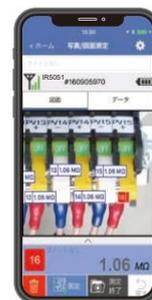
GENNECT Cross se puede utilizar para crear informes en el campo. Puede fotografiar una caja de conexiones y luego colocar los valores medidos en la imagen. De esta manera, puede crear imágenes que vinculen visualmente los valores de medición con sus ubicaciones.
